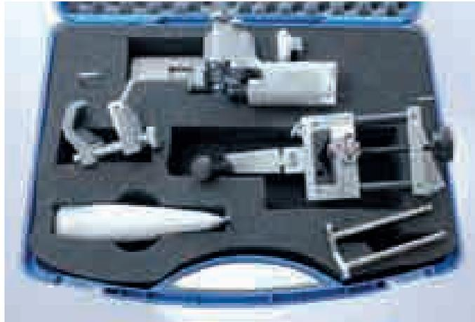
(Abb. Werkzeugkoffer Gr. 1 für kleine Querschnitte)
